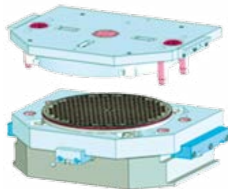
3D-Ansicht der Spritzprägeform, 413 Nester
