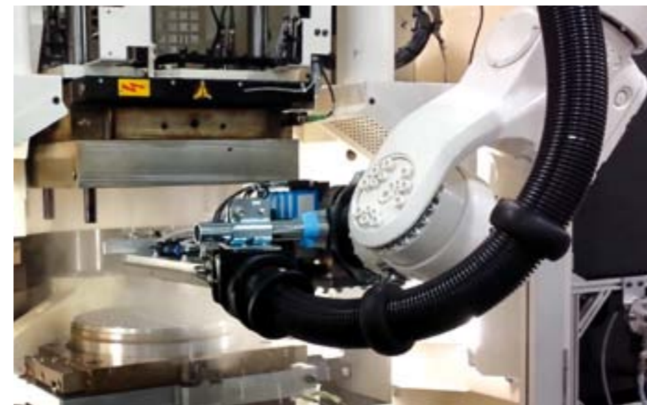
Ansicht des Handlingsystems in der Entformungsphase
