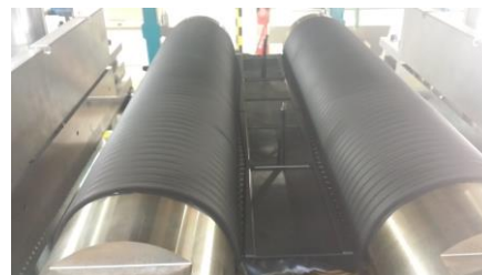
Ansicht der Dichtungen ND110 auf den Kernstangen
