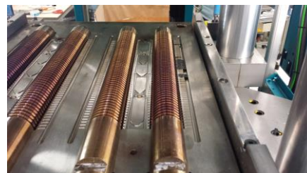
Ansicht der Form (4 Kerne) für Dichtungen ND50
